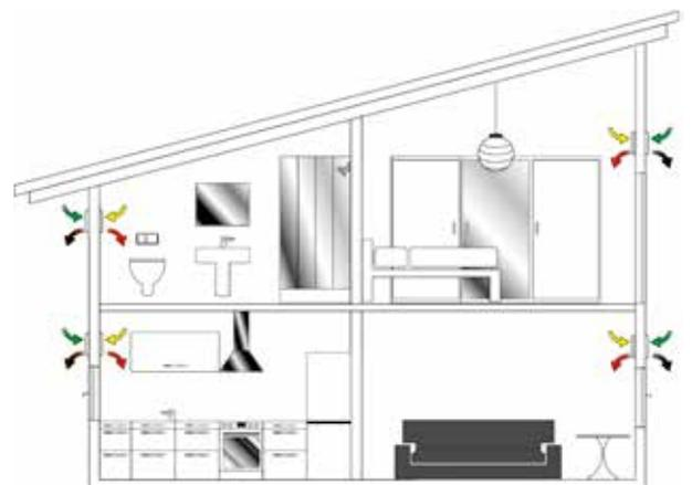
**Dezentrale** Lüftungsgeräte können auch **im Nachhinein** eingebaut werden (mit oder ohne Wärmerückgewinnung). Die Installation erfolgt mittels Kernbohrung in der Außenwand. Die dezentralen Lüftungsgeräte eignen sich gut für die Belüftung einzelner Räume.
